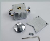
Adattatore per fili/viti o piccoli pezzi con diametro di 0,8 - 10 mm
