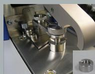
Adattatore per fili di diametro 0,8 - 3 mm
