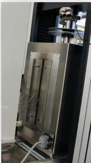
Inserimento estensimetro Micron Motor MFX per prove a caldo con camera termostatica
