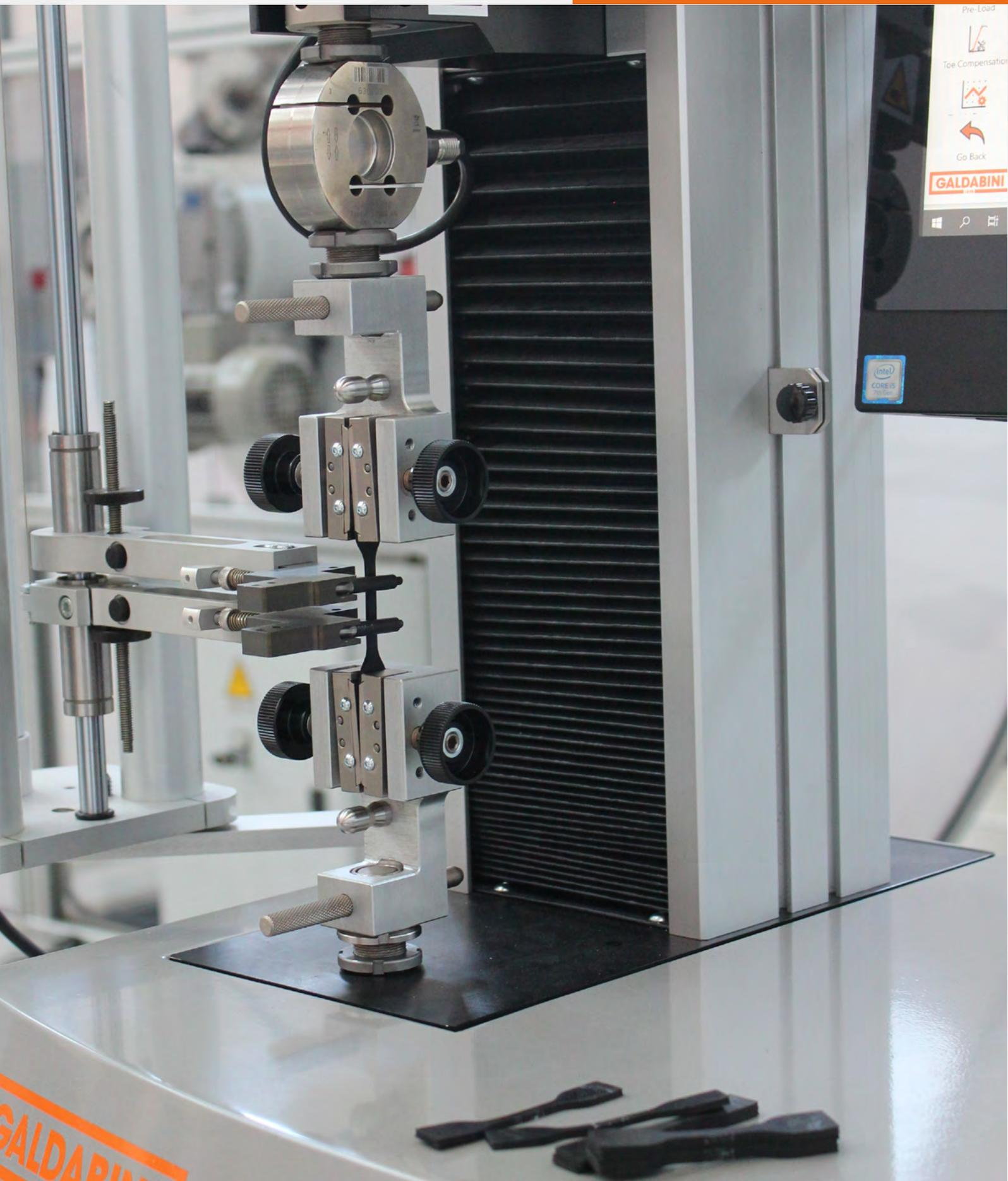
Prova di trazione su elastomero con estensimetro ELAST
