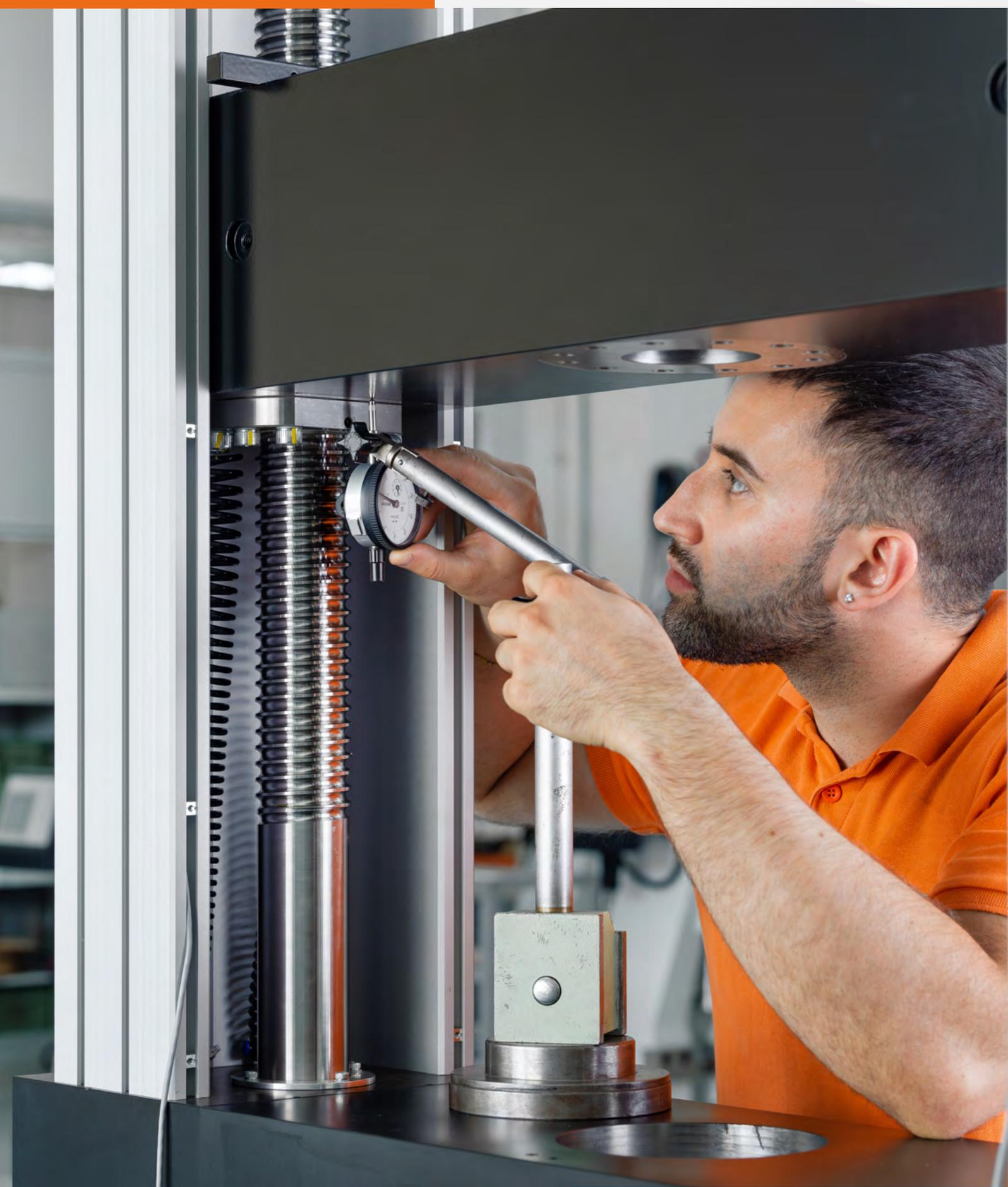
Dettaglio viti a ricircolo e monitoring allineamento della traversa
