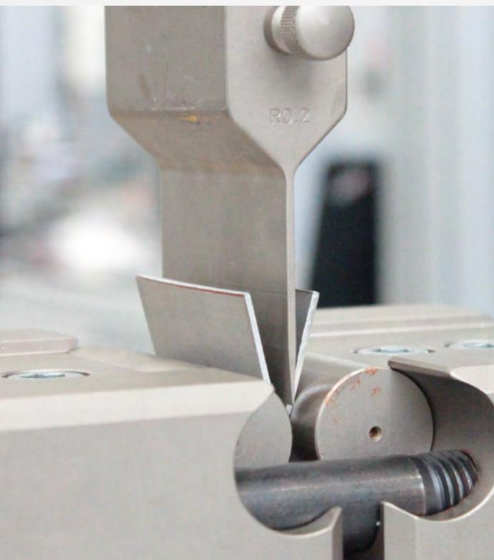
Prova di piegatura provino di metallo
