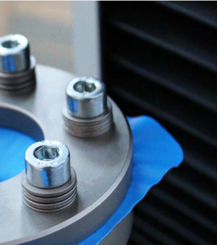
Resistenza alla perforazione di film flessibili secondo ASTM F1306
