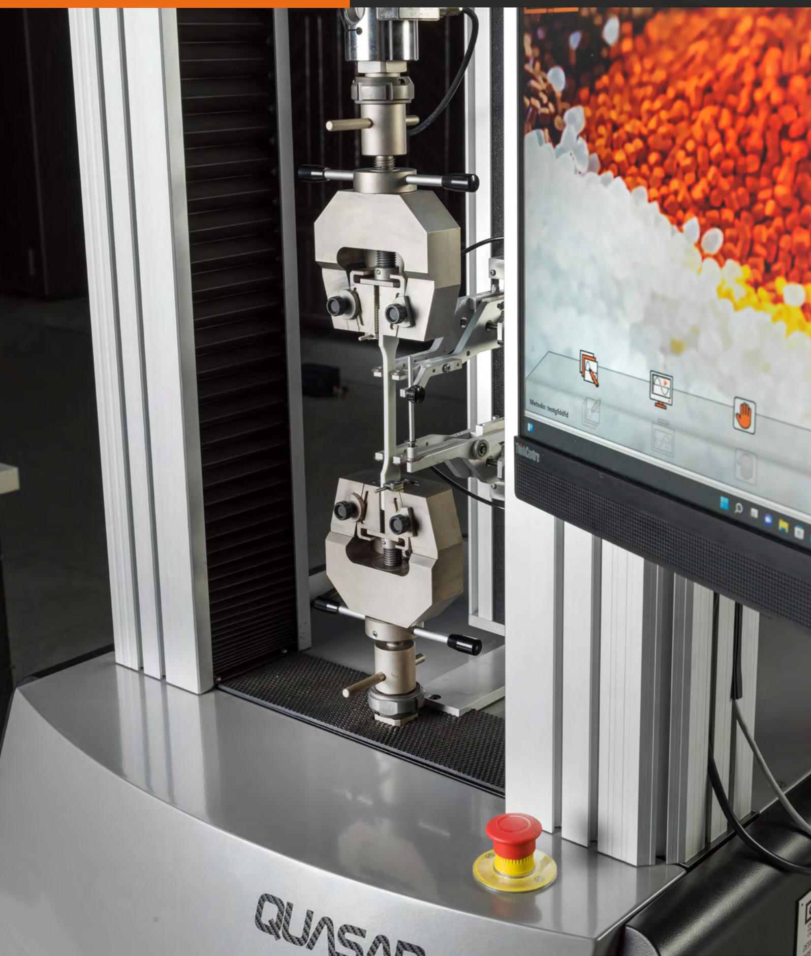
Prova di trazione su plastica rigida con estensimetro MicronXT secondo Norma ISO 527-1
