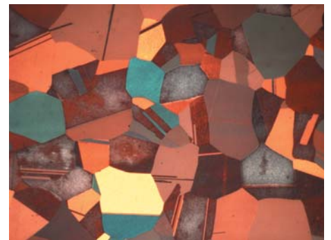
Bronze avec structures doubles de recristallisation, 1:200
