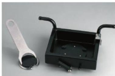
La vasca per il tampone opzionale a doppia parete è disponibile in due formati diversi, per il sezionamento di campioni da 33 x 40 mm o addirittura da 70 x 40 mm.
