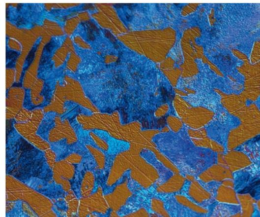
Ferrite C60, perlite ipoeutettoidica, N Plan 50x, BF
