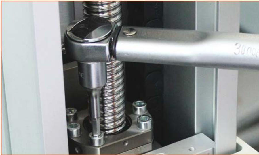
Da oltre 30 anni produciamo macchine di prova materiali elettromeccaniche con movimento traversa mediante viti a ricircolo di sfere, fornendo nel corso degli anni diverse migliaia di macchine alle più importanti aziende in tutto il mondo. Le viti a ricircolo di sfere impiegate rispondono alle migliori classi di precisione ISO. Montatori esperti assicurano un perfetto assemblaggio delle strutture con un preciso allineamento meccanico coassiale dei collegamenti ai morsetti.
