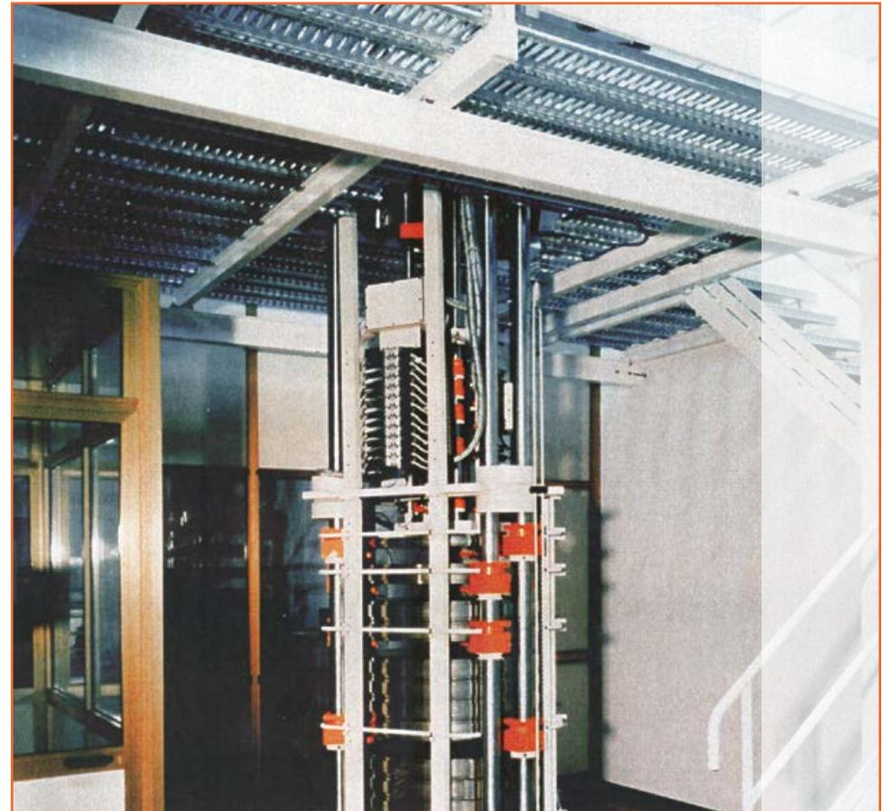
Galdabini è produttore di macchine campione di forza a pesi diretti, installate presso i maggiori centri di ricerca nazionali ufficiali. Il centro metrologico Galdabini a Cardano al Campo utilizza una macchina campione di forza da 500kN per la taratura di precisione delle celle di carico.
